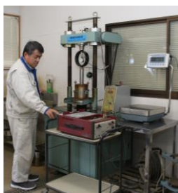
CBR試験状況
