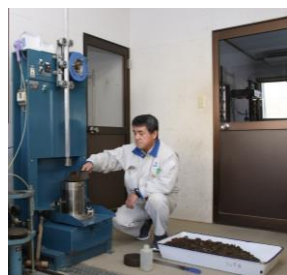
自動締め固め試験状況
