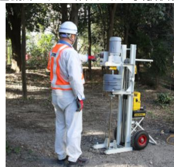
自動スウェーデン式サウンディング試験状況
